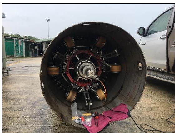
รูปที่ 2-19 การตรวจสอบการกีดร่อนของผิวภายในท่อด้วยการปล่อยกระสวย (Intelligent PIG) เมื่อวันที่ 2 พฤศจิกายน พ.ศ. 2563 และเสร็จสิ้นวันที่ 24 ธันวาคม พ.ศ. 2563
