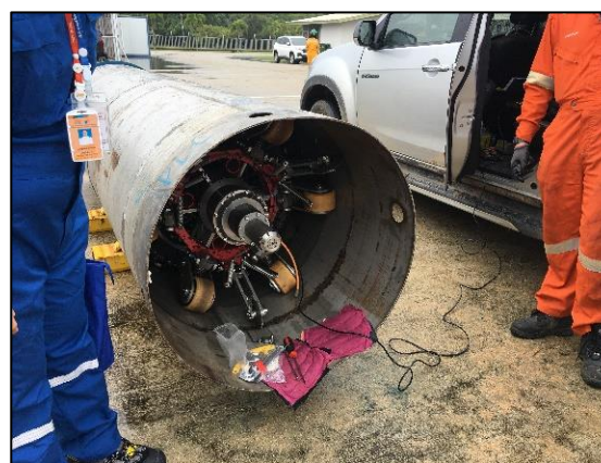
รูปที่ 2-19 การตรวจสอบการกีดร่อนของผิวภายในท่อด้วยการปล่อยกระสวย (Intelligent PIG) เมื่อวันที่ 2 พฤศจิกายน พ.ศ. 2563 และเสร็จสิ้นวันที่ 24 ธันวาคม พ.ศ. 2563
